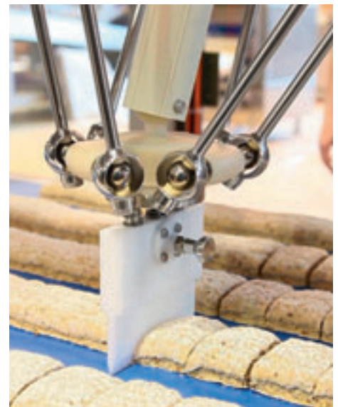
Grammgenaues Portionieren von Brötchen auf bewegtem Förderband
